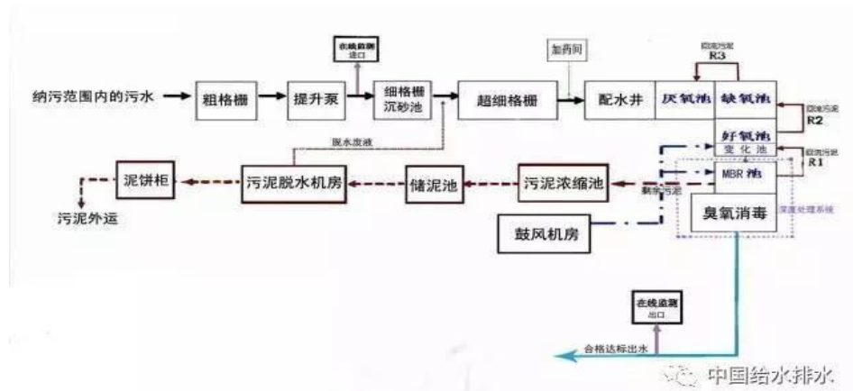
图 4-1 昆明市第四水质净化厂 MBR 系统工艺流程
