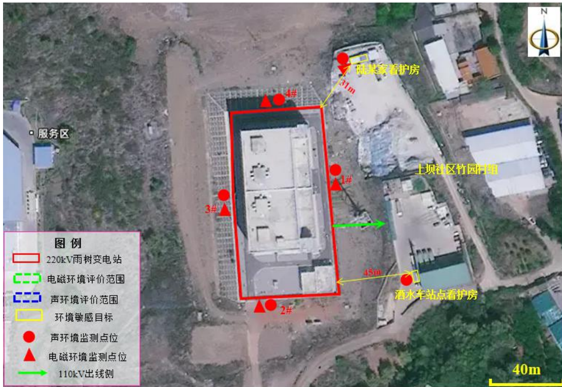
图 39 220kV 雨树变电站监测点位示意图
