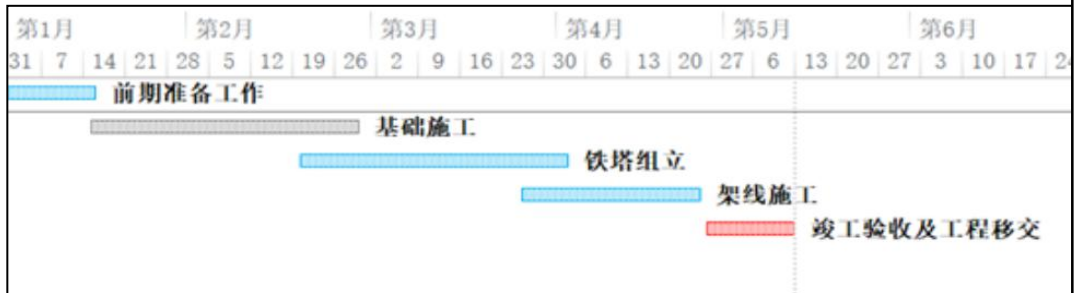
图 13 架空输电线路施工时序图
