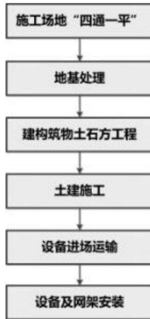
图 7 变电站工程施工工艺流程
