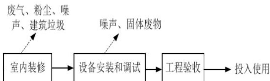
图 2-1 项目施工期工艺流程及产污节点图
